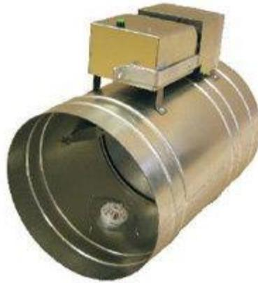
**Огнестойкий клапан КПС-1** (далее клапан) с точки зрения функциональности может использоваться в качестве огнезадерживающего (О) с нормальной открытой заслонкой или дымового (Д) с нормальной закрытой заслонкой, исходя из требований СНиП 41-01-2003. Вид климатического исполнения и категория размещения УЗ по ГОСТ 15150-69.
