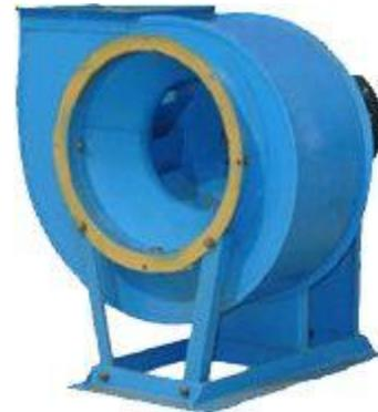
Вентиляторы ВР 80-75 изготовлены из углеродистой стали. Данная продукция применяется для перемещения газов с низким уровнем агрессивности или воздуха с температурой не более 80°C и запыленностью, не превышающей 100 мг/м<sup>3</sup>. Также для эксплуатации вентиляторов ВР 80-75 (ВЦ 4-75) необходимо отсутствие в воздухе липких или волокнистых веществ.
